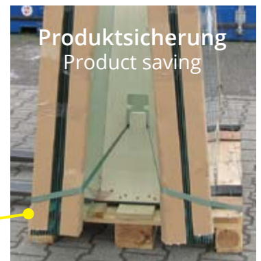
Dieser Test simuliert eine Vollbremsung. Dabei verrutschte die 1000 kg schwere Ware um lediglich 3 mm. This test simulates a full braking. The 1000 kg heavy load has slipped by only 3 mm.
